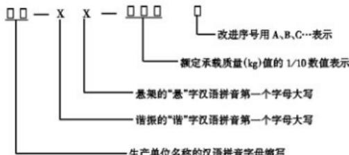
例: □□ - XX - 150A 表示某某公司生产的额定承载质量为 1500kg 的第一次改进型谐振式汽车悬架装置检测台。
